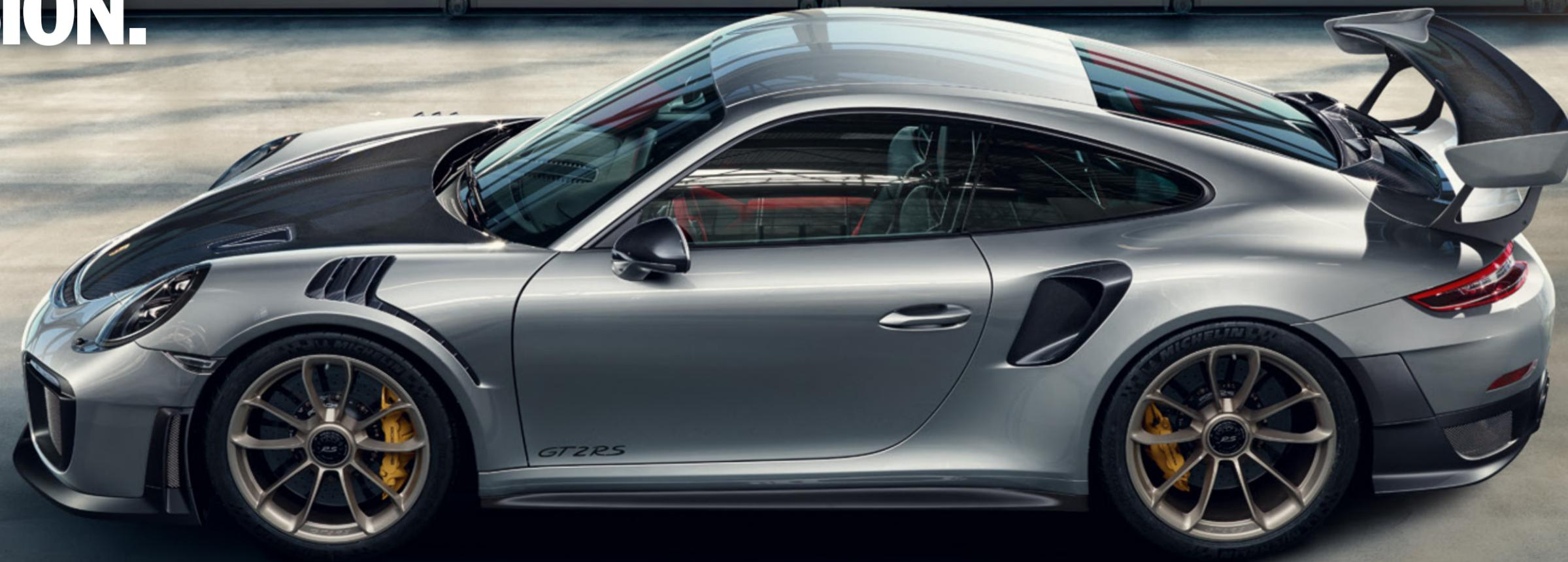
**Conception allégée :** capot avant, ailes, capot et aileron arrière en Carbone, boucliers avant et arrière en Polyuréthane léger, vitres latérales arrière et lunette arrière en Polycarbonate, toit en Magnésium, silencieux en titane.
