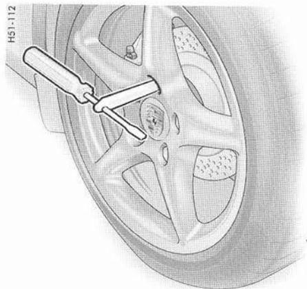
Vissage de l'auxiliaire de montage sur les véhicules **sans** PCCB
