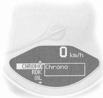
Le chronomètre ne peut être remis à zéro que dans le menu CHRONO via la commande "Reset".
