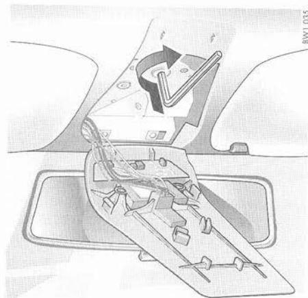
1. A l'aide d'un angle ou d'un tournevis, déclipez avec soin les deux caches **A** de la surveillance infrarouge de l'habitacle.
