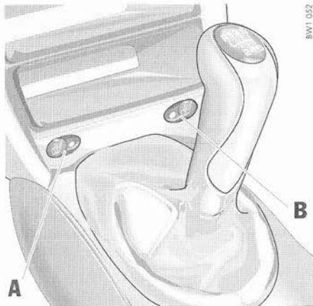
**A** - Chauffage du siège gauche
