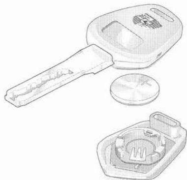
1. Avec l'ongle ou à l'aide d'un petit tournevis soulevez soigneusement le dessus du cache de l'anneau de clé.
